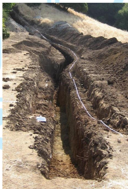
ภาพการขุดร่องสำรวจตามแนวรอยเลื่อน ที่มา http://faultlinegeo.com/?page_id=10
