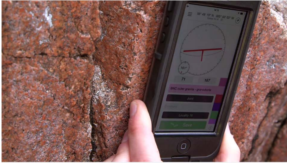
ภาพแสดงการวัดแนวระดับ และมุมเทของชั้นหินด้วยแอปพลิเคชัน FieldMove Clino ที่มา http://www.mve.com/digital-mapping
